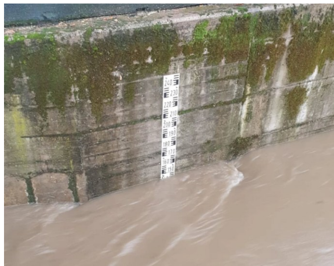
Foto – Asta idrometrica lungo il torrente Pudiga al confine tra Novate M. e Baranzate. Dx livelli registrati durante la piena del 22 settembre 2025 – fonte NOC Novate M.
